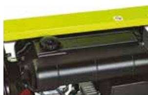
Большой встроенный топливный бак (11 л.) обеспечивает продолжительное время автономии
