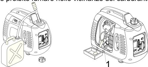
P. Svuotare completamente la benzina contenuta nel serbatoio benzina in un contenitore appropriato.
