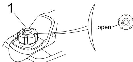
Remarque : lors de la première utilisation ou dans un environnement froid, tournez le bouchon de ventilation du réservoir à carburant sur la position OFF. Tirez la tige du piston jusqu'en haut, puis poussez-le vers le bas 3-4 fois. (Cela va ajouter de la pression dans le système de carburation de sorte que l'essence atteindra le carburateur rapidement accélérera le démarrage du groupe électrogène).
