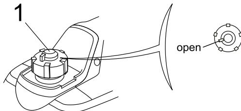
Nota: in caso di primo utilizzo o in ambiente freddo fissare il coperchio di riempimento di carburante fino al palo di ventilazione indica OFF
