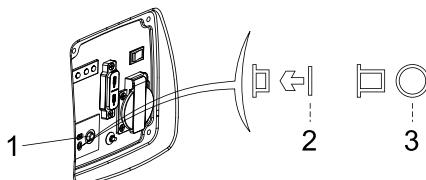
1 - Interruptor de proteção do circuito em corrente contínua
