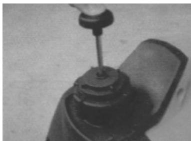
1 - Válvula de ventilação da tampa do bocal do combustível
