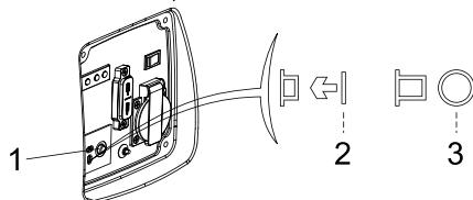
1 – Überlastschalter des 12 V-Stromkreises
