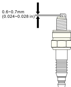
37. Installare la candela a mano, prestando attenzione. Prestare attenzione a non sovrapporre la filettatura a vite.
