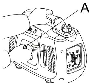
E) Quando o motor está se aquecendo, coloque o controle de tração da válvula de bloqueio do ar na posição “START”.
