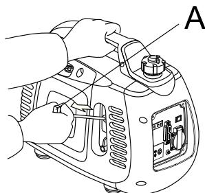
t) Quando il motore si sta riscaldando, portare il controllo a trazione della valvola di bloccaggio aria nella posizione "START".
