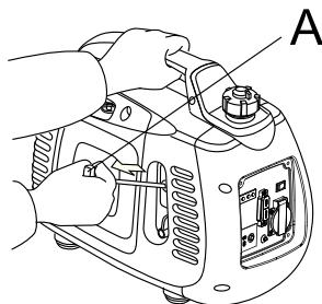
o) Cuando el motor se haya calentado, gire el terminal de tracción de la válvula de bloqueo del aire hacia la posición "START".
