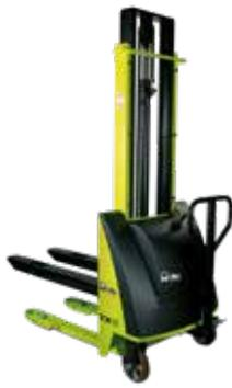
Tracción manual y tecnología de elevación electrohidráulica
